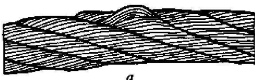
Рисунок 17 – Выдавливание проволок прядей: а — в одной пряди; б — в нескольких прядях
