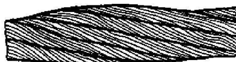
Рисунок 16 – Местное увеличение диаметра каната
